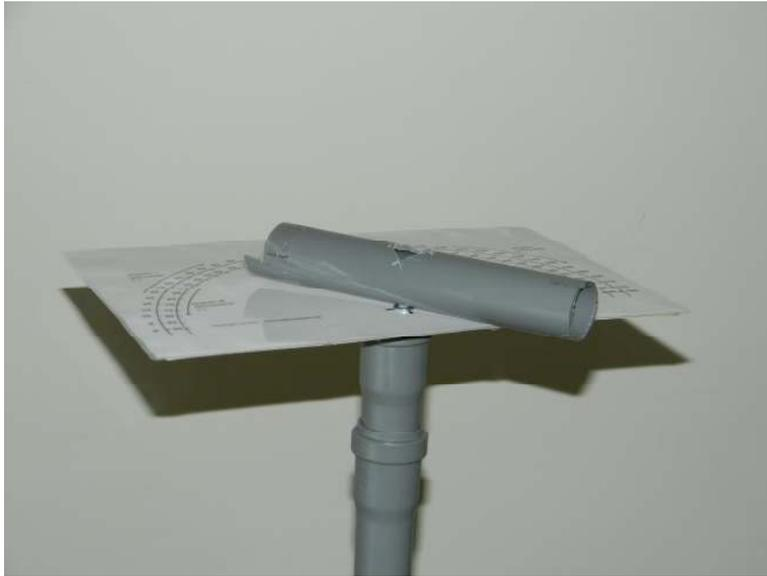
per misurare gli angoli verticali (elevazione e depressione), effettuiamo l'innesto tramite il gomito, come mostrato nella seguente foto.
